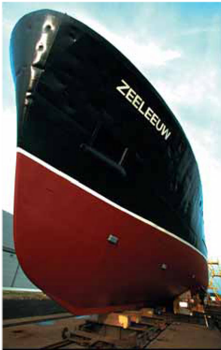
Op de wand van een stalen schip worden onder de waterlijn verschillende zinkblokken bevestigd. Het stuk zink zal geleidelijk wegcorroderen en daarbij het ermee verbonden deel van de stalen scheepsromp beschermen tegen corrosie (VL)
