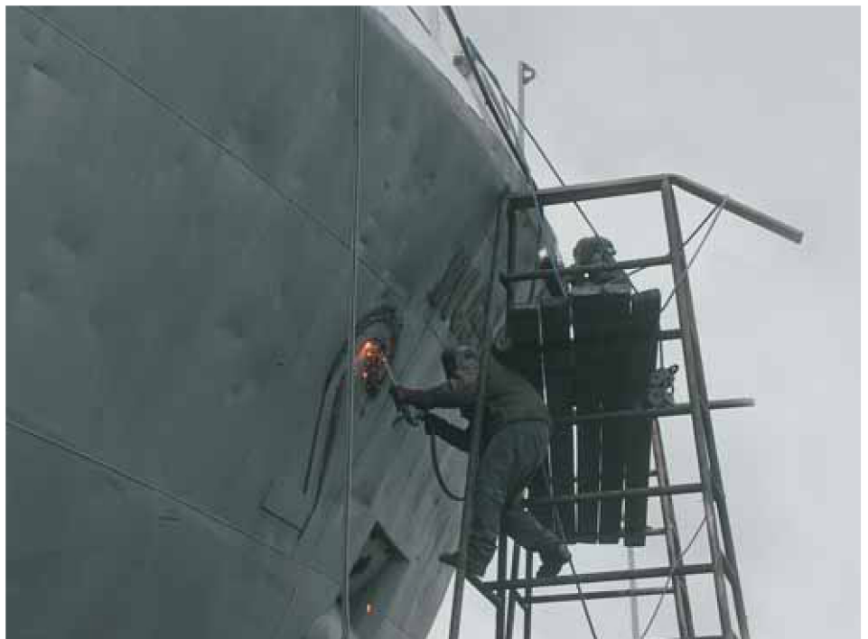
Bij het lassen van een stalen schip verbindt men de platen waaruit de scheepshuid opgebouwd is door de randen van de twee te verbinden delen te verhitten tot hun smeltpunt. Gelaste schepen kwamen in omloop rond de tweede wereldoorlog. Daarvoor werden de platen waaruit een schip was opgebouwd aan elkaar geklonken met klinknagels (VL)
