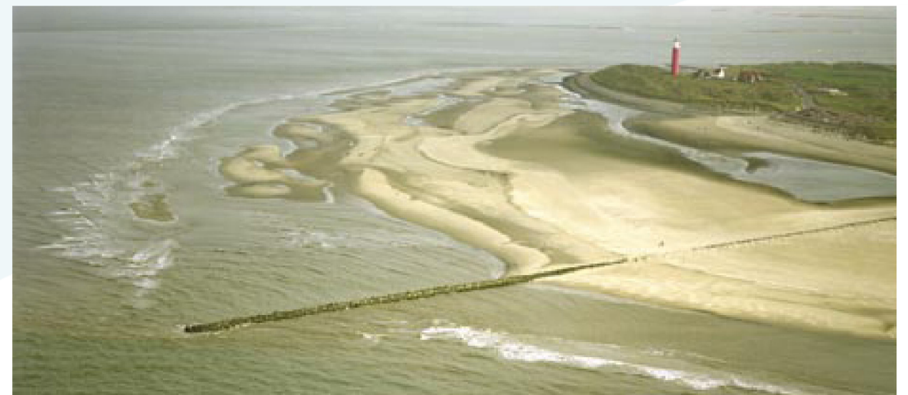
De Eijerlandse dam (loodrecht op de kust) bleek een zandvang van formaat.
