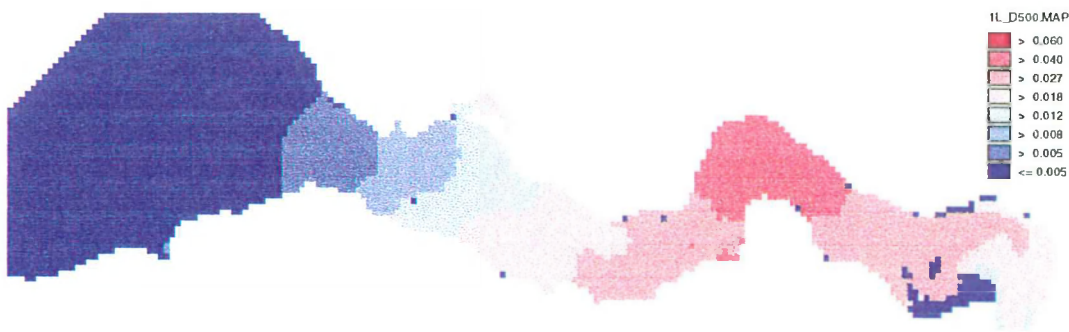
Figuur 8 2DH verspreiding continue lozing na 14 dagen. (horizontaal geen aggregatie, D = 500 \text{ m}^2 \cdot \text{s}^{-1} , Euler backward)
