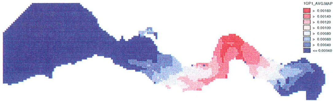
Figuur 13 3D verspreiding instantane lozing na 4 dagen, resultaat over de verticaal gemiddeld. (Geen aggregatie, D = 1 \text{ m}^2 \cdot \text{s}^{-1} , Euler backward)
