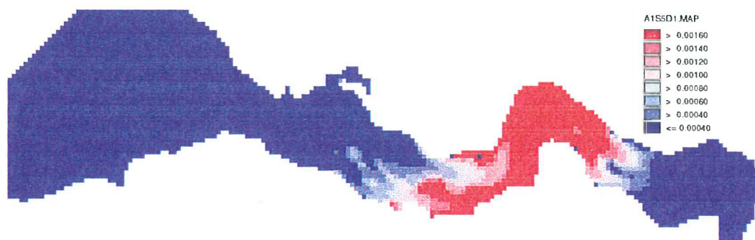
Figuur 10 2DH verspreiding instantane lozing na 4 dagen. (horizontaal geen aggregatie, D = 1 \text{ m}^2 \cdot \text{s}^{-1} , flux corrected transport)
