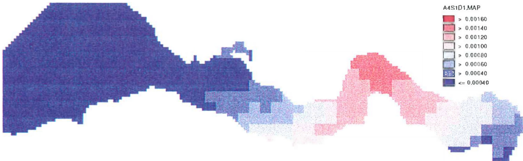
Figuur 27 2DH verspreiding instantane lozing na 4 dagen (horizontaal 4 bij 4 geaggregeerd, D = 1 \text{ m}^2 \cdot \text{s}^{-1} , Euler backward)
