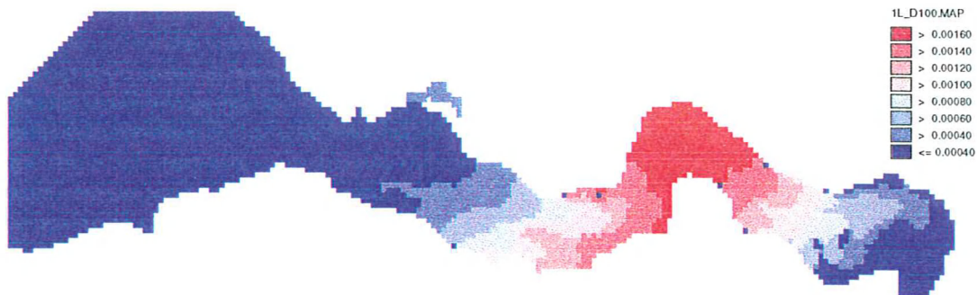
Figuur 15 2DH verspreiding instantane lozing na 4 dagen. (horizontaal geen aggregatie, D = 100 \text{ m}^2 \cdot \text{s}^{-1} , Euler backward)
