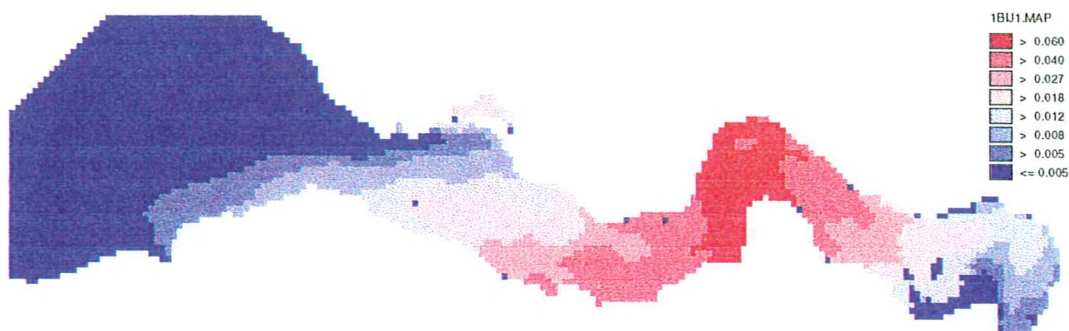
Figuur 6 2DH verspreiding continue lozing na 14 dagen. (horizontaal geen aggregatie, D = 1 \text{ m}^2 \cdot \text{s}^{-1} , Euler backward)
