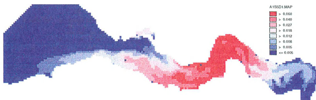
Figuur 2 2DH verspreiding continue lozing na 14 dagen. (horizontaal geen aggregatie, D = 1 \text{ m}^2 \cdot \text{s}^{-1} , flux corrected transport)
