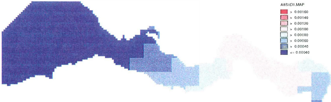
Figuur 28 2DH verspreiding instantane lozing na 4 dagen (horizontaal 8 bij 8 geaggregeerd, D = 1 \text{ m}^2 \cdot \text{s}^{-1} , Euler backward)
