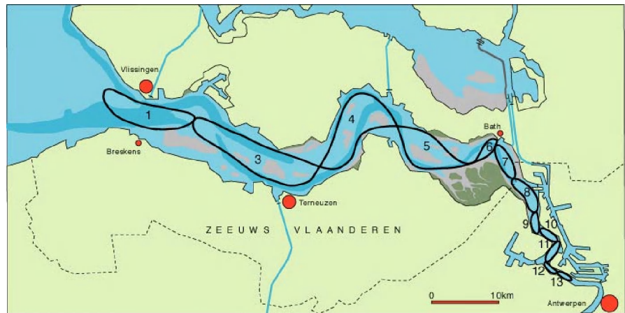
Figuur 5. Macro cellen in de Westerschelde (Winterwerp et al. 2000, Jeuken 2001). Iedere cel bestaat uit een ebgedomineerde (eb)geul en een vloedgedomineerde (vloed)geul met daartussen een plaat. De grote geulen vormen de macro-cellen. Meso-cellen zijn geassocieerd met de kleinere geulen of inscharingen en zijn niet weergegeven in dit figuur.
