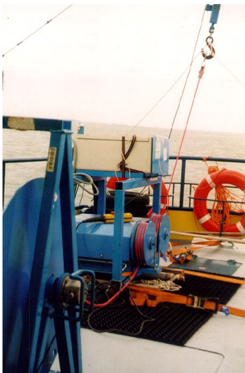
Figuur 6: Opstelling pully en lier aan dek van de "Kaloo"
