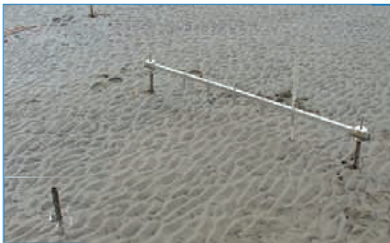
Figuur 4.3 Een driehoeksplot. De bodemhoogte wordt op vijf punten van iedere zijde van de driehoek gemeten (Foto C. Joosse)
