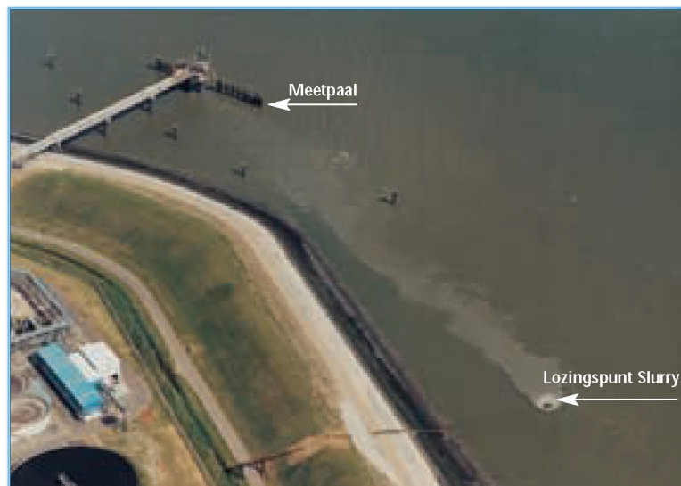
Figuur 5.3 Luchtfoto van de verspreiding van de slurry op 26 juni 2001 om 10.37 u zomertijd. In de foto is het lozingspunt van de slurry en meetpaal Scheldesteiger DOW aangegeven (Foto Sky Pictures Arnhemuiden)
