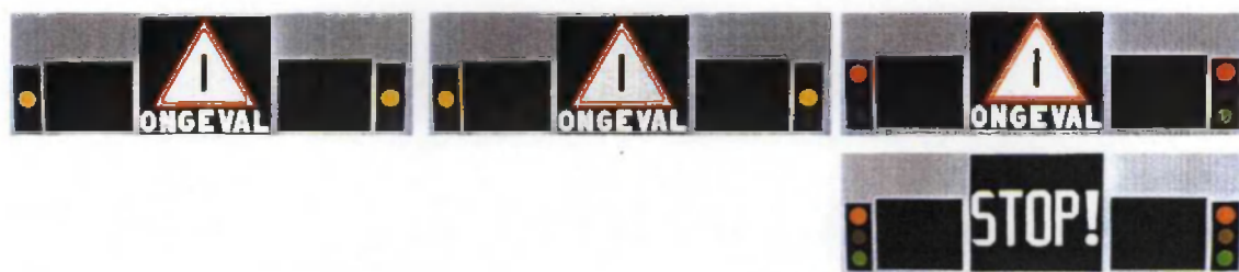
Fig. 5 Signalering die getoond wordt bij een abrupte stopstrategie. Gedurende de eerste 10 seconden wordt signalering (1) getoond, met knipperende oranje verkeerslichten. Na 10 seconden treedt signalering (2) in werking, met vast oranje. Na 30 seconden alterneren signalering (3a) en (3b).
