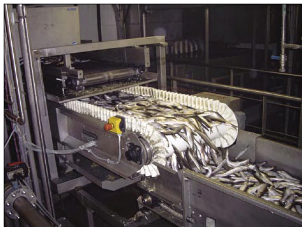
Abbildung 4: Wiegeband der Bandwaagenanlage mit darüber liegendem Entwässerungsgitterband.
