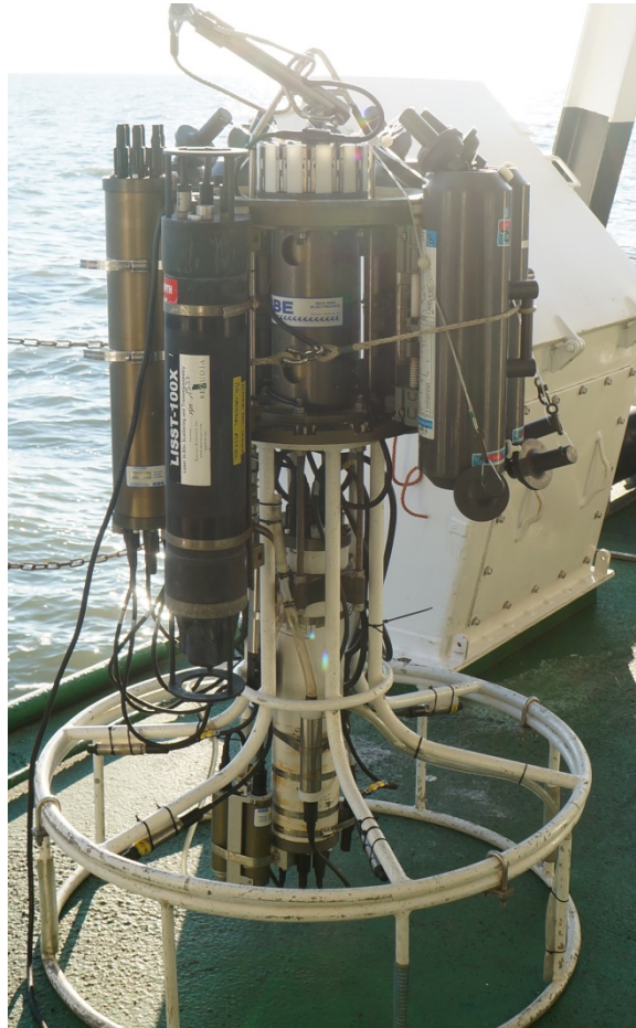
Foto 3. Rosette met 2 Sea-Bird SBE9plus systemen en een LISST-100X.
