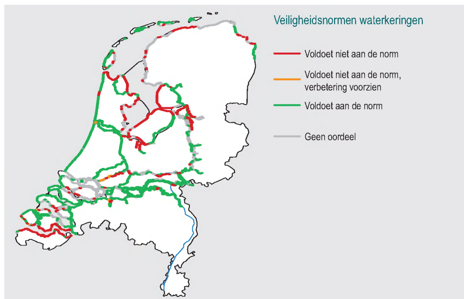
Figuur 5.3.1 Primaire waterkeringen die anno 2001, na toetsing, niet bleken te voldoen aan de veiligheidsnormen in de Wet op de waterkering.
