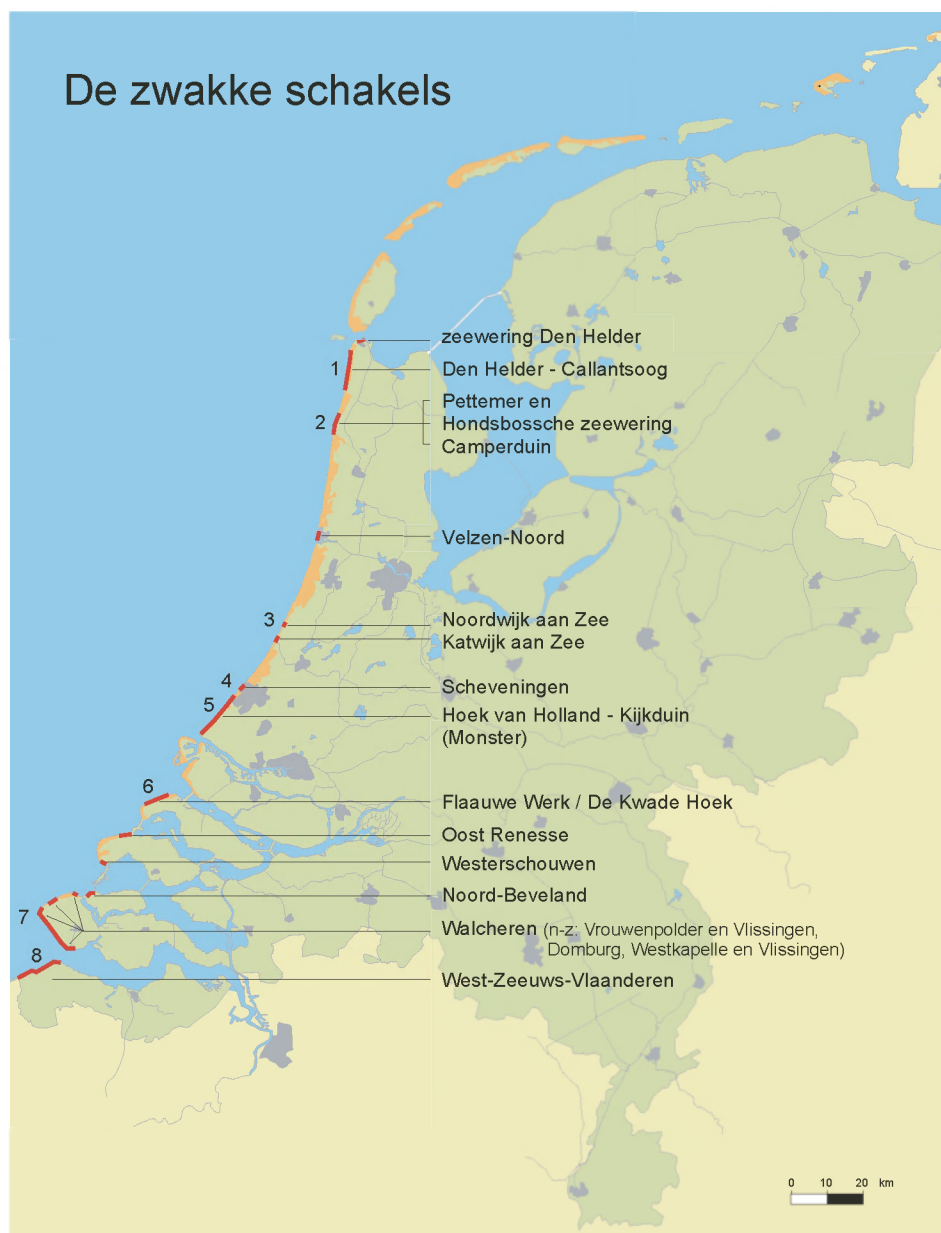
Figuur 3.2.1 Zwakke schakels langs de kust. De genummerde plekken zijn de 8 schakels waarvoor momenteel door de provincies integrale planstudies worden opgesteld, zowel vanuit het oogpunt van ruimtelijke kwaliteit als vanuit het oogpunt van veiligheid van het achterland. De niet genummerde plekken zijn eveneens geïdentificeerd als (toekomstige) zwakke schakels maar hiervoor is versterking ten behoeve van de veiligheid niet op korte termijn noodzakelijk (Bron: Ministerie van Verkeer en Waterstaat; 2002b, 2003d).
