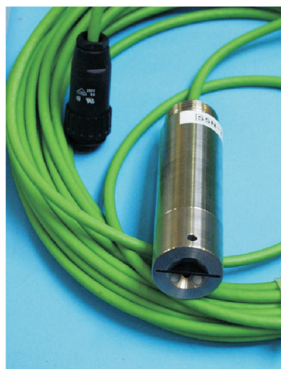
De turbiditeitsmeter door het WLH gebruikt is een Staiger Mohilo, type 7100 MTF, met een SSN sonde
