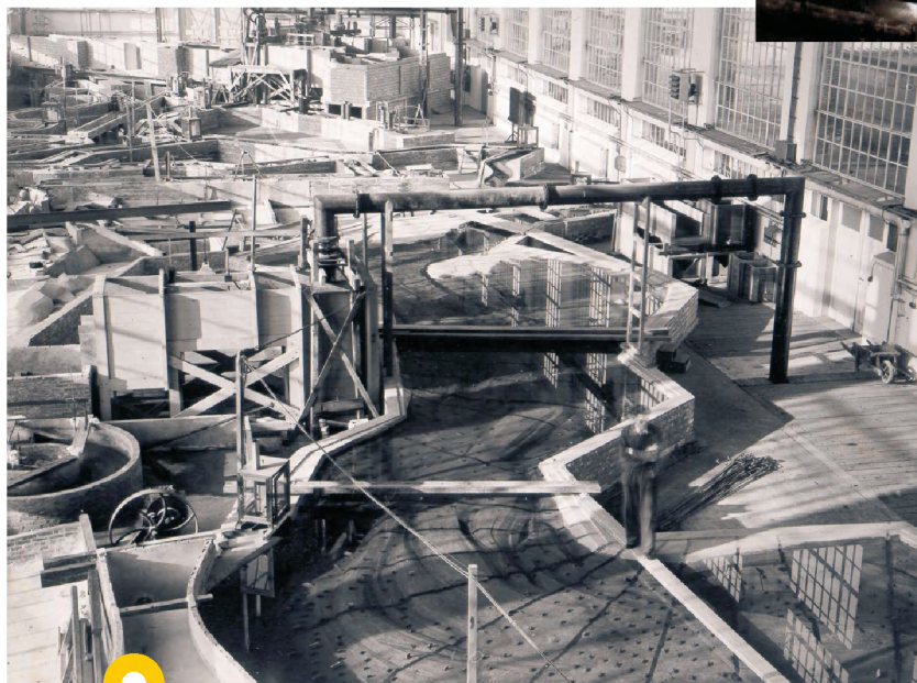
Eerste tijmodel van de Schelde (Mod. 36)
