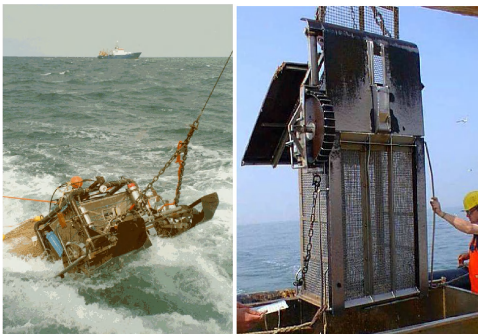
Figuur 38: (a) triple-D (NIOZ). (b) bodemschaaf (RIVO).
