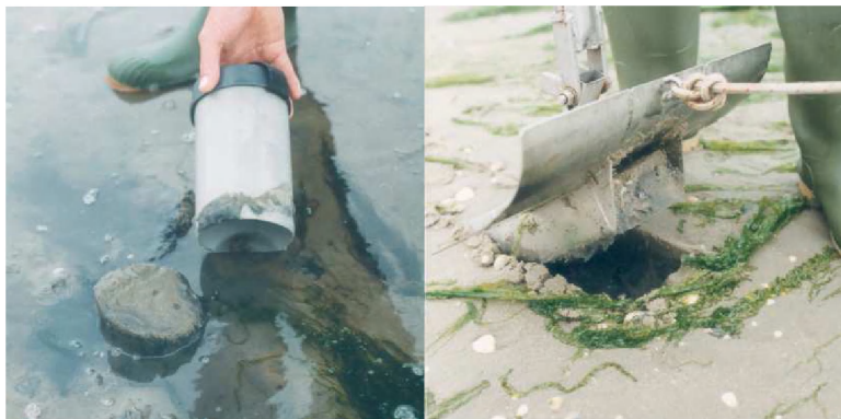
Figuur 9 Steekbuis (links) en kokkelschuif (rechts) die worden gebruikt voor de IMARES-survey (Bult et al. 2004)
