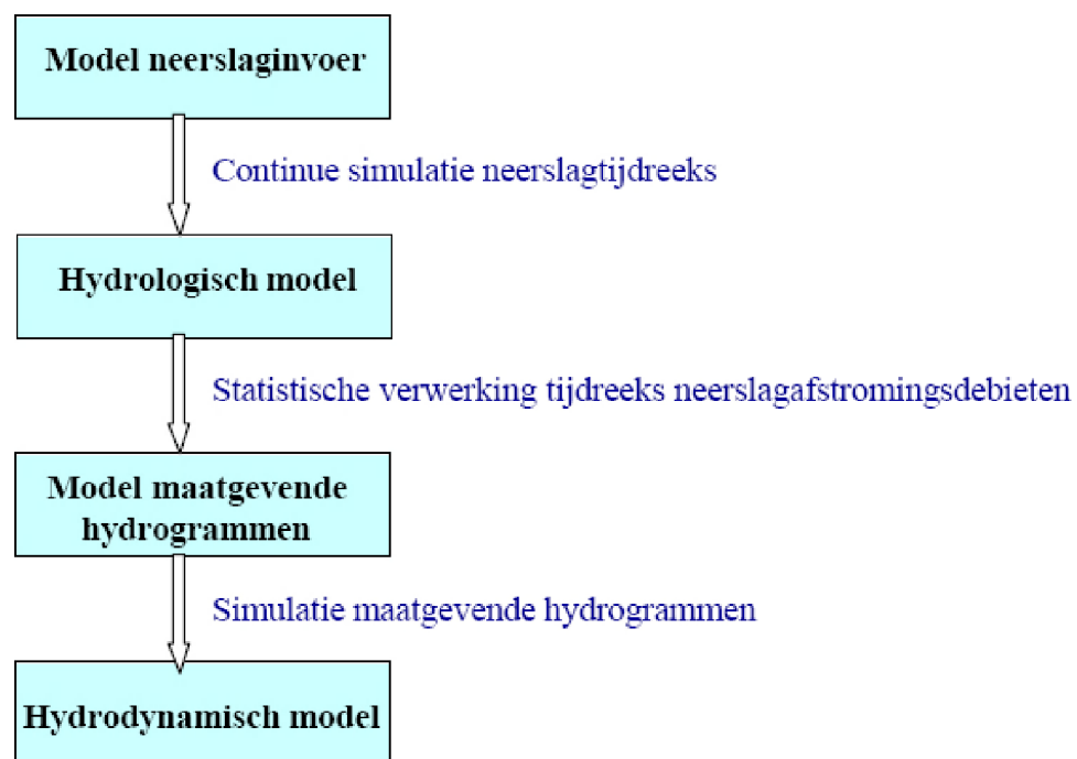
Figuur 2.1 Schematisch overzicht van de aanbevolen methode voor het berekenen van de intrinsieke variatie in de tijd (uit Willems, 2007).
