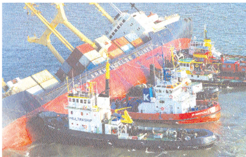
• Bij een aanvaring in 1994 op de Westerschelde, raakte een Russisch schip zodanig beschadigd dat het dreigde te kapseizen. Multraship wist het schip te behouden door het tegen een zandbank te drukken en het later, na noodreparaties, met behulp van het opkomend getij weer overeind te zetten.
