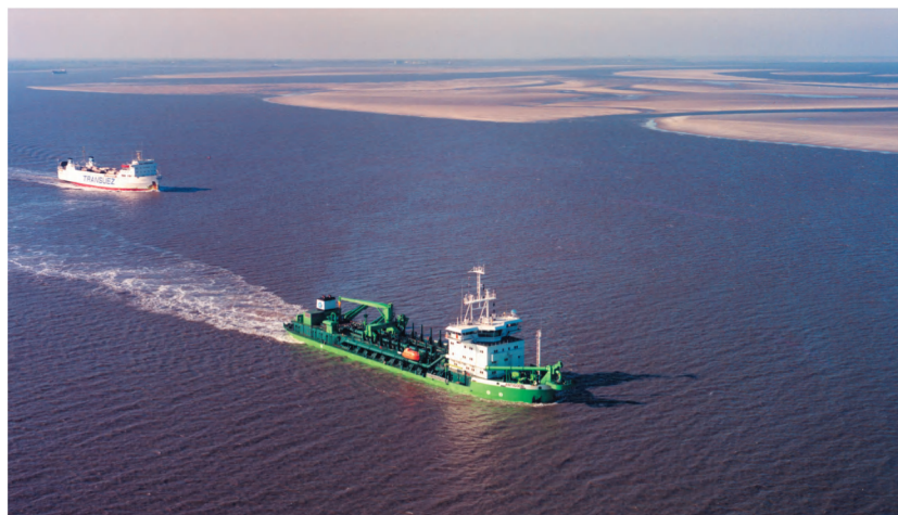
● De Antigoon is een sleepopperzuiger die op de Schelde ingezet wordt voor het uitvoeren van baggerwerken. DN
