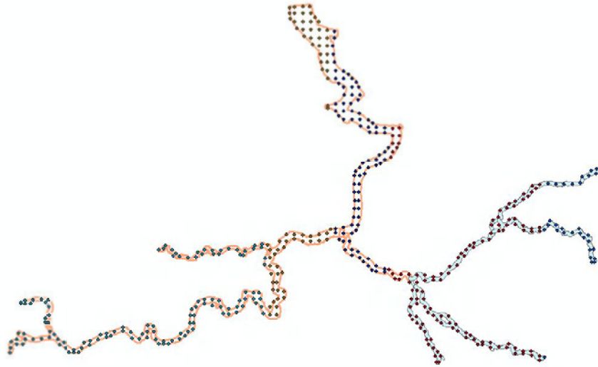
Figuur 43. Deze kaart van het te karteren stroomgebied geeft de bedekking van de LiDAR data weer. De punten duiden op het middelpunt van de gefilterde DTM laserpunten bestanden.
