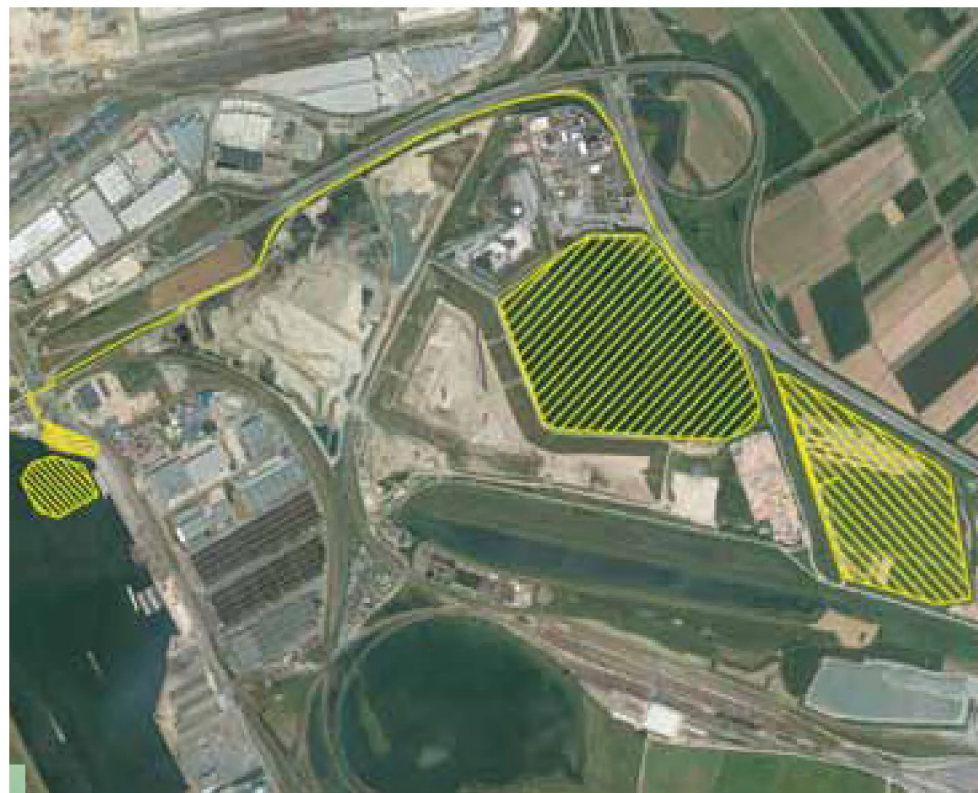
De locatie van het AMORAS-project met links de 'ontvangstzone' van de baggerspecie (kanaaldok B1-B2), centraal de stortplaats voor de ontwaterde 'koeken' (Zandwinningsput) en rechts de verwerkingssite (Bietenveld).
