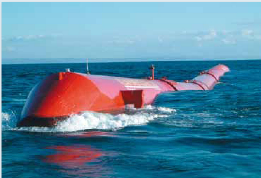
Pelamis, de drijvende golfenergieconverteerder. Deze 140 meter lange, torpedovormige convertoren bewegen mee met de golven van de zee. Ze zijn verbonden met een hydraulisch systeem dat de golfbeweging gebruikt om onder hoge druk olie in enkele hydraulische motoren te pompen. Die motoren drijven dan weer generatoren aan die elektriciteit produceren. ©Pelamis
