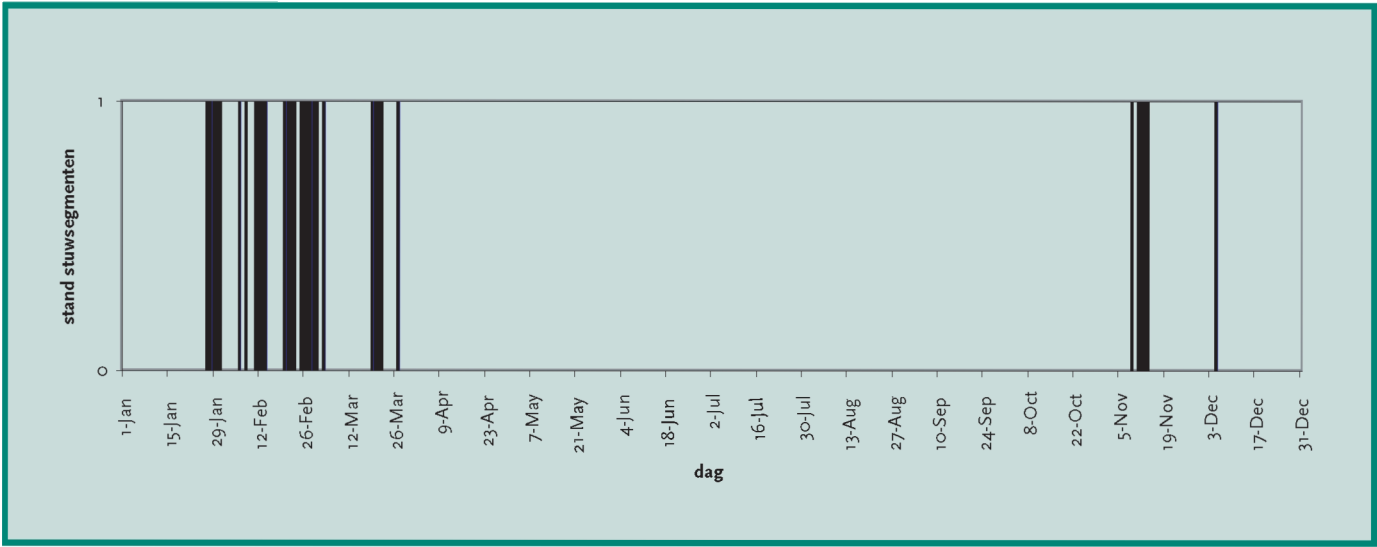
Figuur 3.16: Dagelijkse stand van de stuw van Merelbeke vanaf 1 januari 2002 t.e.m. 31 december 2002. “Stand 1 = stuw geopend”: dit betekent dat de stuw op die dag minimaal 4 u volledig heeft open gestaan, m.a.w. dat beide stuwsegmenten volledig opgetrokken zijn. “Stand 0” betekent dat minstens 1 van de 2 stuwsegmenten niet volledig opgetrokken werd gedurende die dag.
