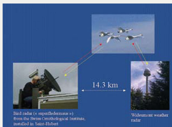
FIGUUR 6.4. Observatiecampagne van het ESA/FlySAFE-project met als doel de weerradars te gebruiken om de migratie van vogels in real time te detecteren.
