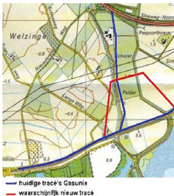
Figuur 6.8 Mogelijke omlegging van leidingen Gasunie
