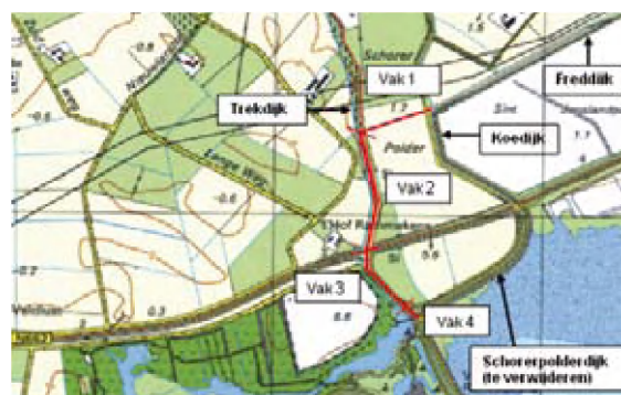
Figuur 5.6 Tracé en dijkvakken nieuwe primaire waterkering
