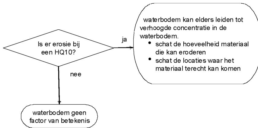
Figuur 4.12 Schema over mogelijke afwenteling tijdens hoogwater. HQ10 is een hoogwatergebeurtenis met een herhalingstijd van tien jaar.
