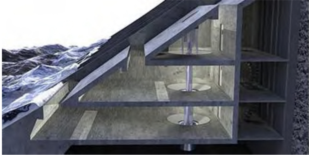
Figuur II-8: De meertrapsturbine van de SSG [20]
