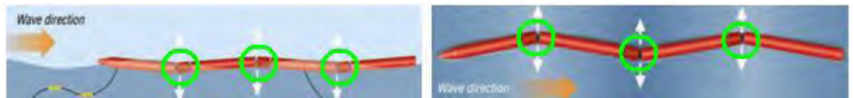
Figuur II-5: De drie conversiemodules van de Pelamis in zij- en bovenaanzicht [18]
