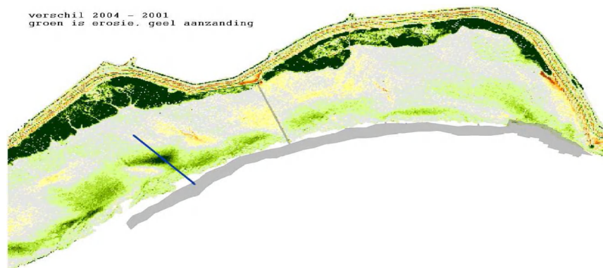
Fig. 10 Verschilkaart laseraltimetrie slik 2004 – 2001 en ligging bestorting Blauw is ligging dwarsprofiel, zie ook Fig. 6.
