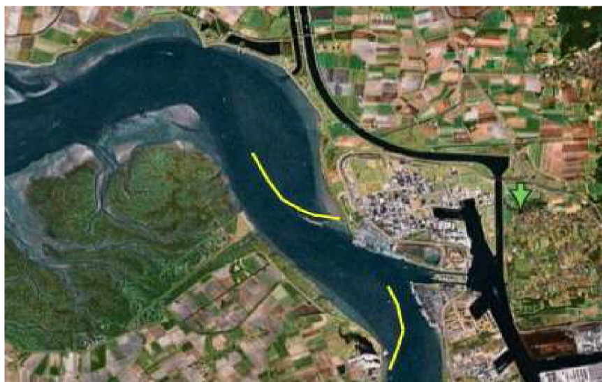
Fig. 12b De twee strekdammen die bij Antwerpen in de Schelde zijn aangelegd (zie ook bijlage A).
