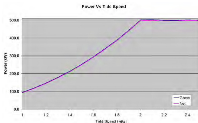
Figuur 12: Stingray “power curve” voor de geplande 2e generatie.
