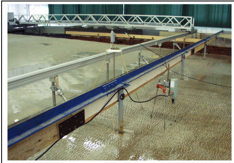
Studie van stabiliteit van de ontworpen havendam voor Oostende op fysisch schaalmodel in de golfgoot
