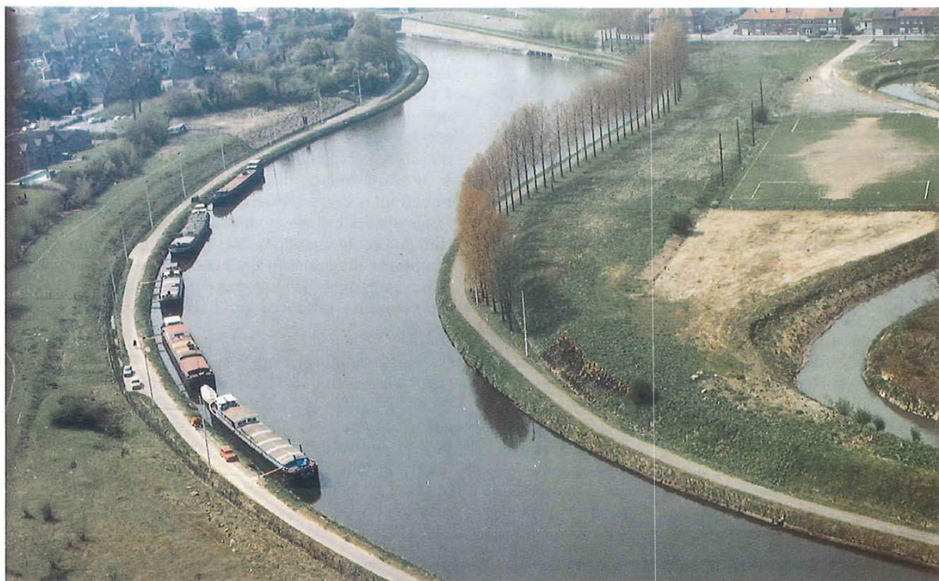
Fig. 113. Lembeek. Le canal à 600 t avec la surlargeur dans les courbes.
