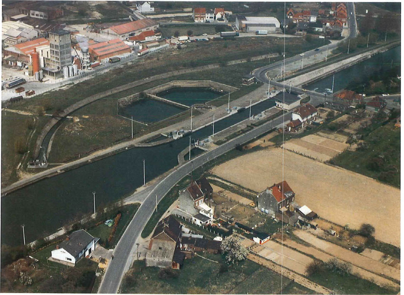
Fig. 112. Lembeek. L'écluse à 600 t avec ses deux bassins d'épargne.
