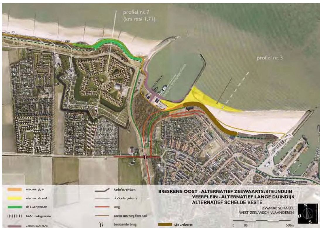
Figuur 6-5 Luchtfoto combinatie van alle voorkeursalternatieven voor het traject Breskens: alternatief Scheldeveste, voor het Veerplein alternatief Lange dijk en voor Breskens Oost het alternatief Zeewaarts Steunberm.
