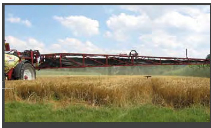
Veldmeting voor het bepalen van het effect van het gewastype op de hoeveelheid spuitdrift
