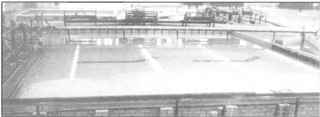
Figuur 1. Fysisch schaalmodel met beweegbare bodem.
