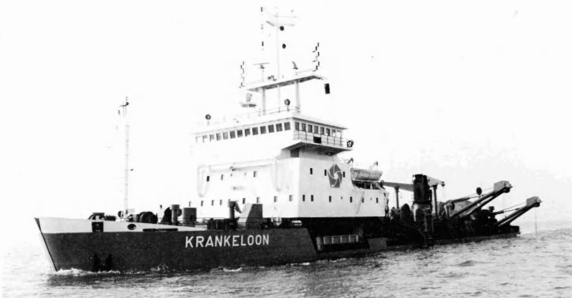
Eén van de sleeptuigperzuigers die permanent worden ingezet voor het onderhoud van de maritieme toegang naar Antwerpen. De kwaliteit van de baggerspecie vormt één van de problemen bij de Belgisch-Nederlandse onderhandelingen omtrent de Waterverdragen.
