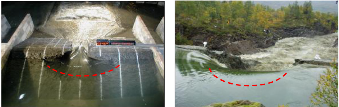
Figuur 4.6 Vorming van een 'boogvormige' drempel voor de bresopening, voorgesteld door streepjeslijn (bron: FLOODsite)
