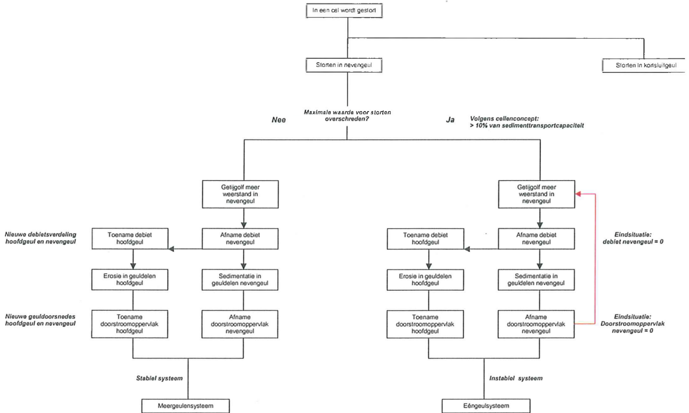
Figuur 7.2: Schema denkmodel voor een cel – storten
