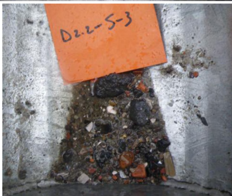
Figuur C-10 Referentiezone D2.2: sediment korrelgrootteverdeling van de Shipek samples bij volle vloed
