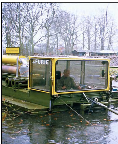
Fig. 13: Baggerboot voor herstel van het Naardermeer
