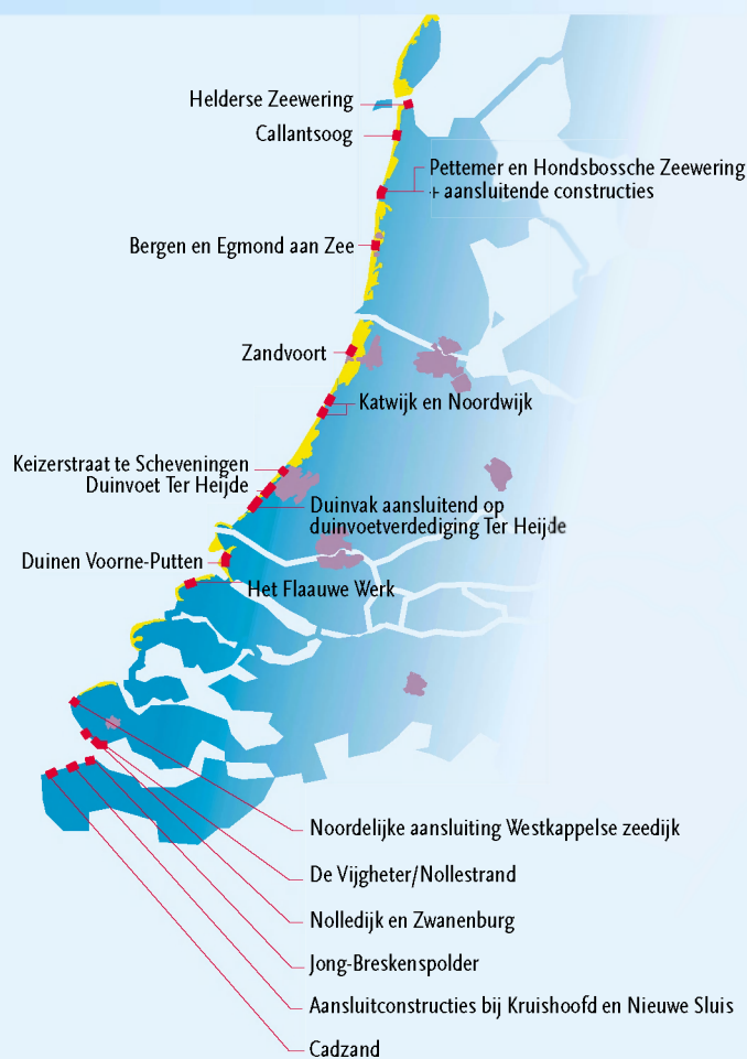
1.1.1 Beheerdersoordeel: waterkeringen voldoen niet aan de norm
