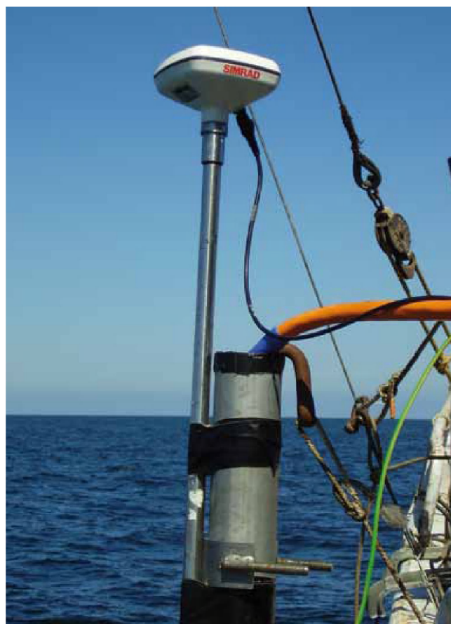
FIG. 9 DGPS-antenne vastgemaakt aan de ijzeren staaf van de echosounder. De dikke oranje kabel leidt het gereflecteerde akoestische signaal naar de opnameapparatuur. DGPS antenna fixed to the iron staff of the echo sounder. The orange cable conducts the reflected signal to the recording equipment.
