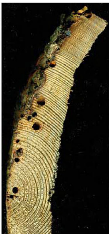
FIG. 53 Doorsnede van één van de tonduigen (BW327) met doorboringen van de paalworm.
