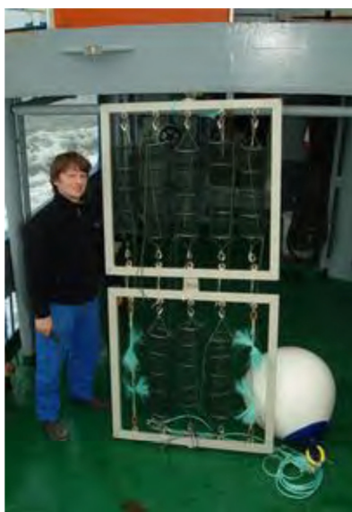
Fig. 10-24 - De mosselkooistructuur met aparte kooien in één grote vlottende kooi Belgische kooisysteem voor de offshore kweek van mosselen gebruikt door Reynaert-Versluys.
