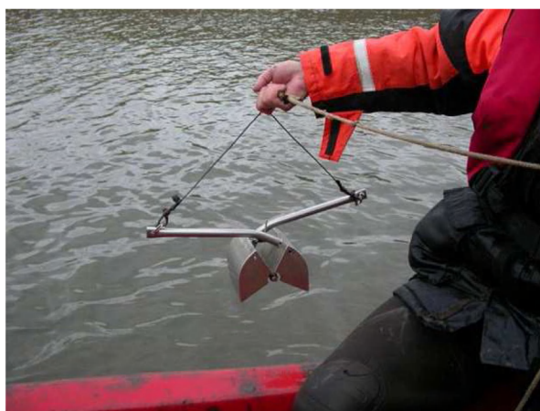
Figuur 6. Van Veen grijper (links) en gezeefd bodemmateriaal (rechts).
