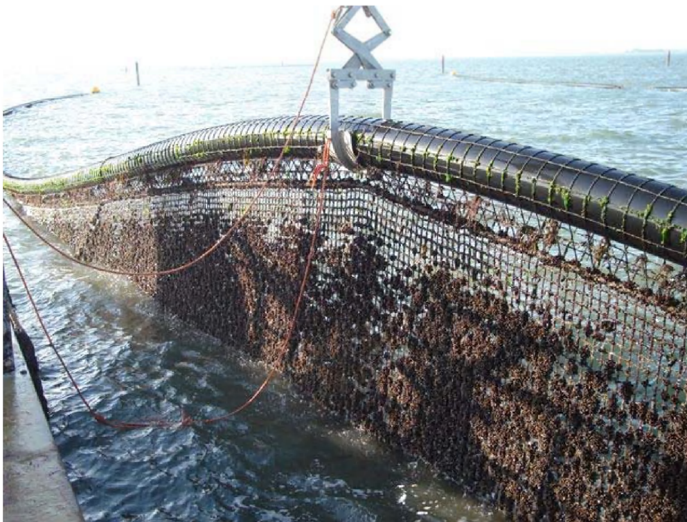
Figuur 19 MZI installatie in de Vuilbaard. Netten met een maaswijdte van 5 cm hangen onder een drijvende buis
