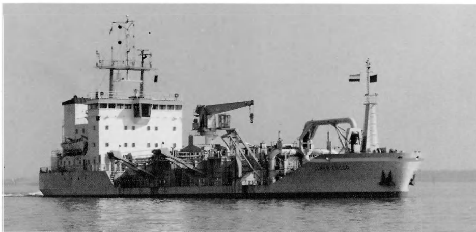
Sleephopperzuiger 'James Ensor'. Bouwjaar 1980. Beuninhoud 3600 m 3 . Dit schip is tevens uitgerust met een walpersinstallatie, vooraan op het schip.
