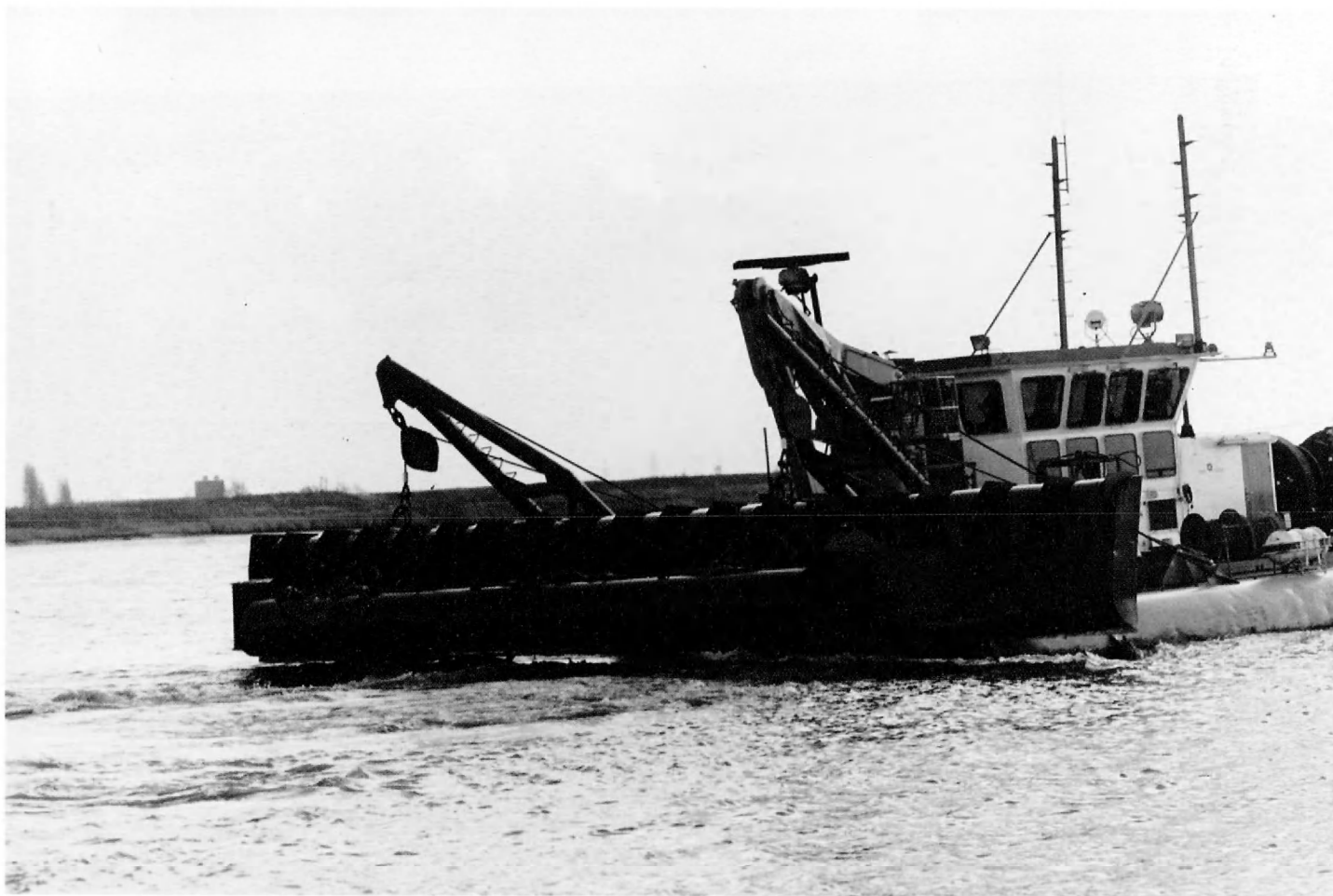
Het bulldozerblad waarmee het schip 'Alligator' is uitgerust. Afmetingen van het bulldozerblad of sweep-beam: breedte 18 m - hoogte 2 m.
