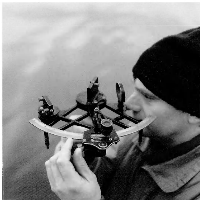
Op de linkse foto de sextant zoals die tot voor 10 jaar gebruikt werd voor de plaatsbepaling, op de rechtse foto het moderne elektronische plaatsbepalingssysteem waarmee alle peilschepen en baggerschepen zijn uitgerust.
