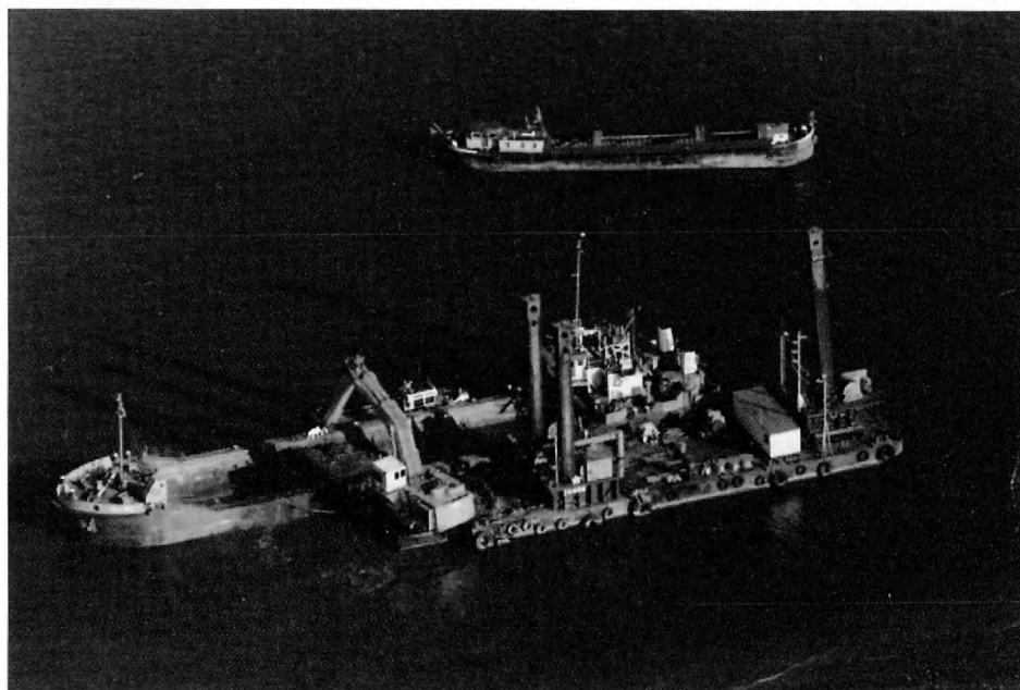
Dieplepel baggerponton 'Zenne', uitgerust met een hydraulische kraan type Demag H185 met een vermogen van 746 kW. De kraan is uitgerust met een dieplepel van 8 m 3 .
