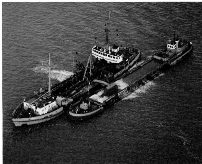
Stationaire steekzuiger 'Dender', tevens uitgerust met een bakkenlaad installatie. Bouwjaar 1959
