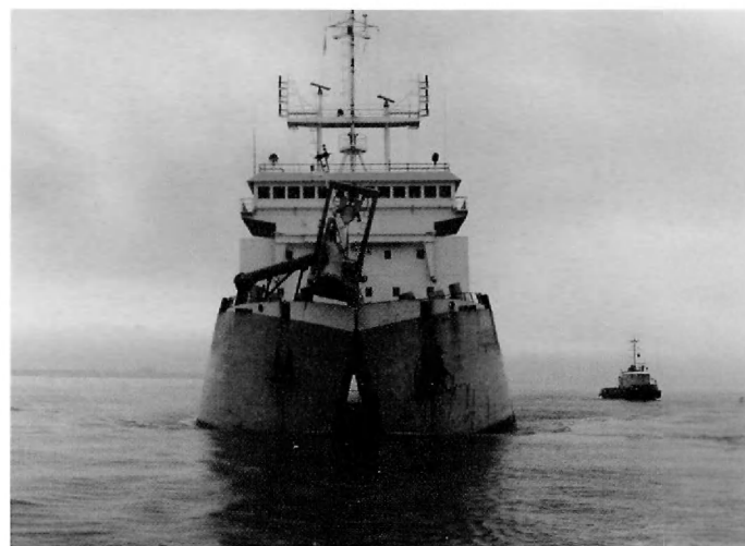
Sleephopperzuiger 'Krankeloon'. Bouwjaar 1980. Beuninhoud 2.700 m 3 . Deze sleephopperzuiger is van het splijttipe.
