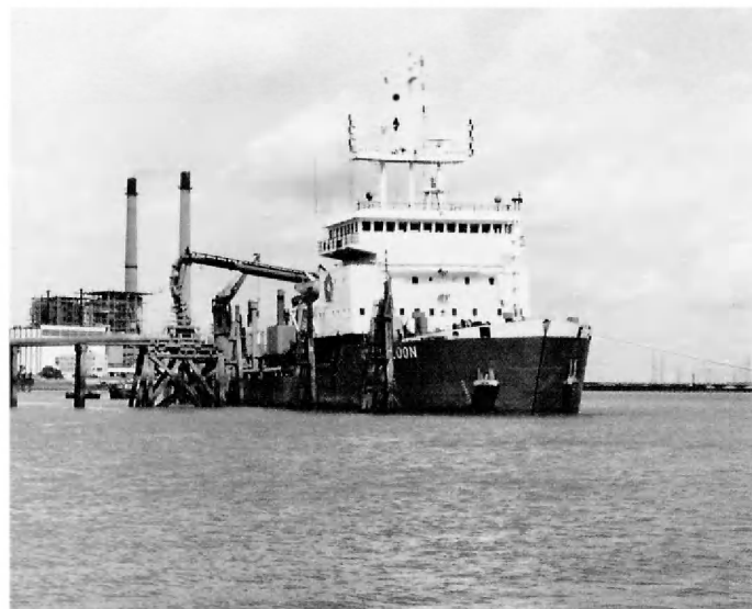
Walpersinstallatie zoals vroeger gebruikt ten behoeve van rechtstreeks oppersen aan de wal door middel van een sleeplopperzuiger. Dit systeem vergde steeds grote investeringen voor de bouw van de aanlegsteiger.
