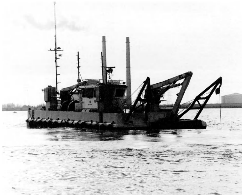
Sweep-beam handling vessel 'Alligator' uitgerust met een onderwater bulldozerblad t.b.v. het slibvrij houden van de toegangseulen van de grote sluisen v.d. haven van Antwerpen. De 'Alligator' heeft een totaal vermogen van 2.300 kW en is uitgerust met 4 Aquamaster propellers welke een uitstekende wendbaarheid geven.
