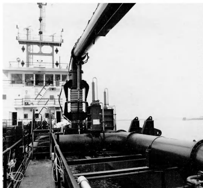
Beun van de splitsleephopperzuiger 'Orwell' met bovenaan de walpersinstallatie.
