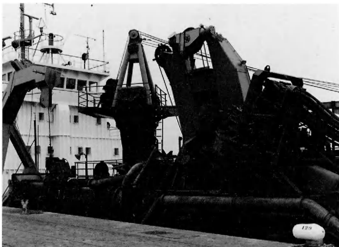
Sleephopperzuiger 'Maas'. Bouwjaar 1973. Beuninhoud 3.170 m 3 . Deze foto toont de onderwaterpomp gemonteerd halverwege de sleeppijp.
