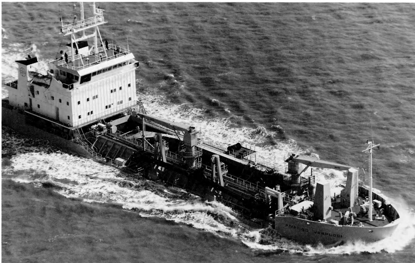
Splijtsleephopperzuiger 'Amerigo Vespucci'. Bouwjaar 1986. Beuninhoud 3.500 m 3 . Deze zuiger is ondertussen ook reeds uitgerust met een boegkoppeling om aan wal te kunnen persen.
