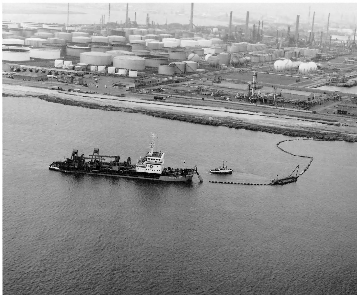
Moderne walpersinstallatie waarbij geen gebruik wordt gemaakt van een steiger; de koppeling met een drijvende leiding wordt gerealiseerd via de boeg van het schip.
