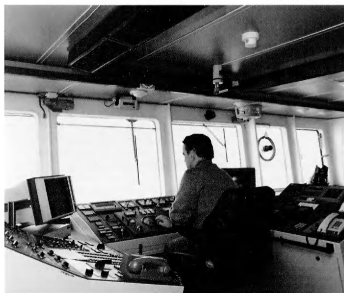
Brug van een sleeppopperzuiger. Links het beeldscherm voor de plaatsbepaling en rechts van de bediener het kleuren beeldscherm van de radar.
