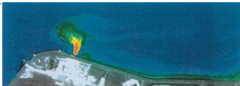
Figuur 4.2: Warmtelozingsbeeld Eemscentrale bij hoog water (Fraikin & van den Bergs, 1996). In de pluim met het groene, gele en rode gebied is het water meer dan 2 graden warmer dan het water in het estuarium.
