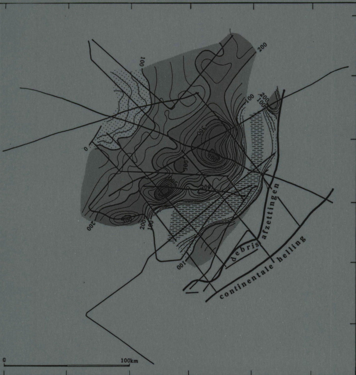
figuur 68. Dikte van de wf3.2-sequentie, berekend aan de hand van een gemiddelde seismische snelheid in de sedimenten van 2000 m/s (interval : 25 m). Lokalisatie van de ch3.2-channelzone.
