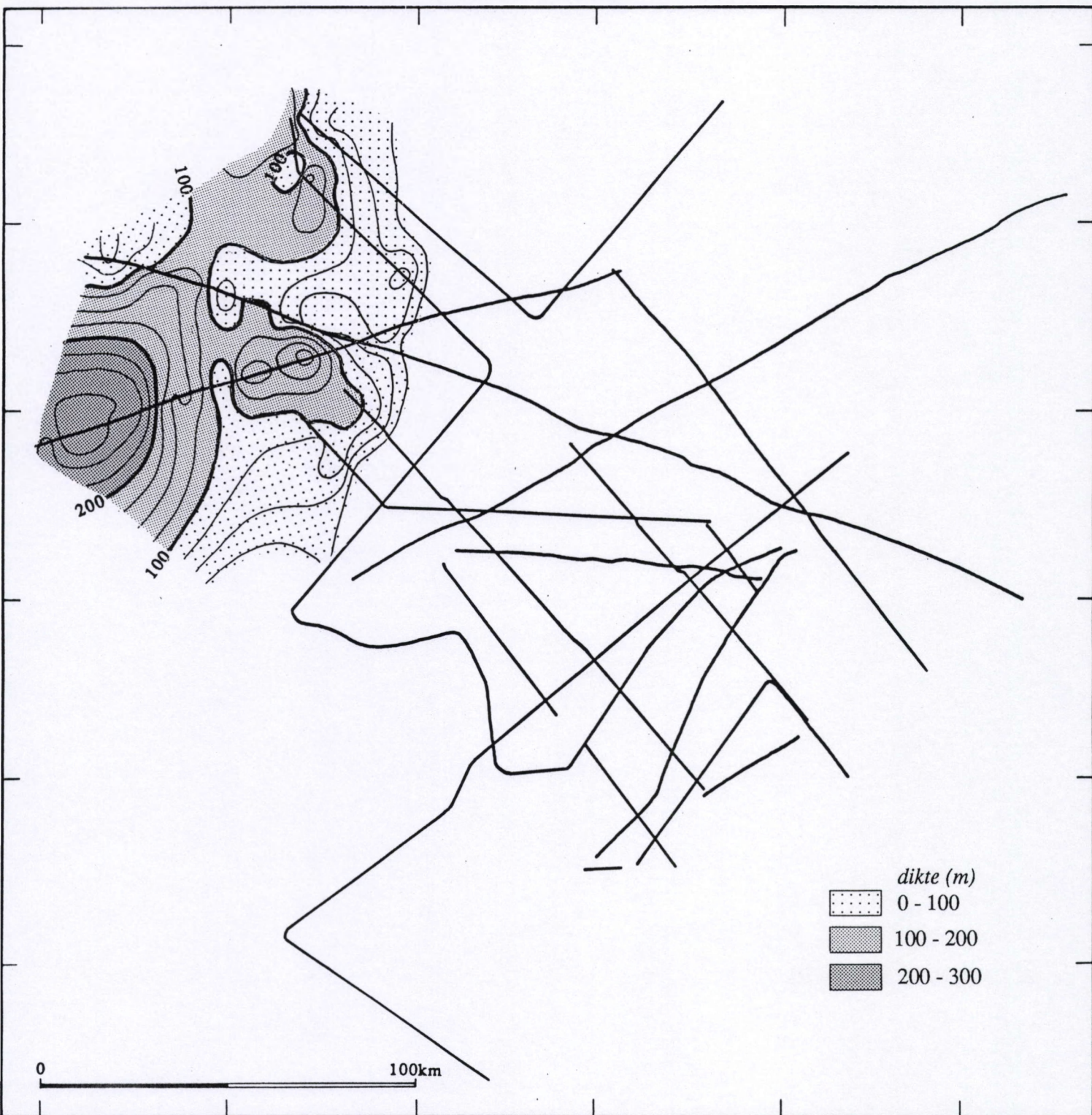
Figuur 57. Dikte van de wf1-sequentie, berekend aan de hand van een gemiddelde seismische snelheid in de sedimenten van 2000 m/s (interval : 25 m).
