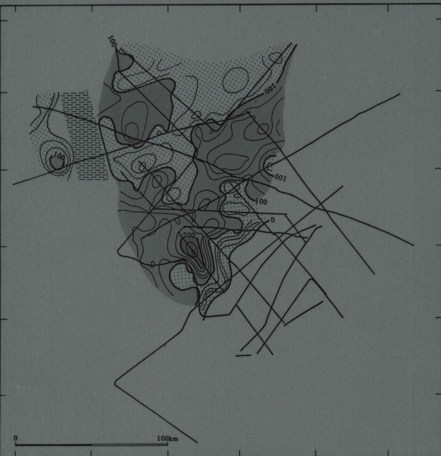
Figuur 64. Dikte van de wf2.4-sequentie, berekend aan de hand van een gemiddelde seismische snelheid in de sedimenten van 2000 m/s (interval : 25 m). Lokalisatie van de ch2.4-channelzone.
