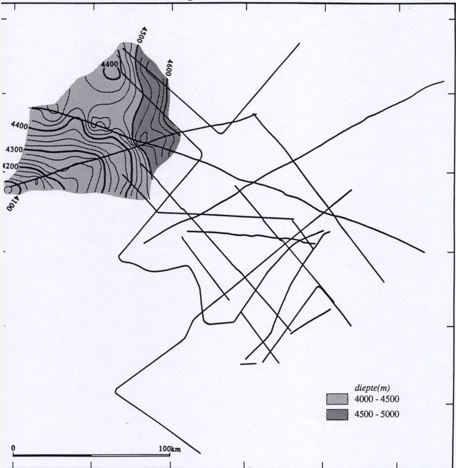
guur 58. Diepte van de horizont WF2.1, berekend aan de hand van een gemiddelde seismische snelheid in de sedimenten van 2000 m/s (interval : 250 m).
