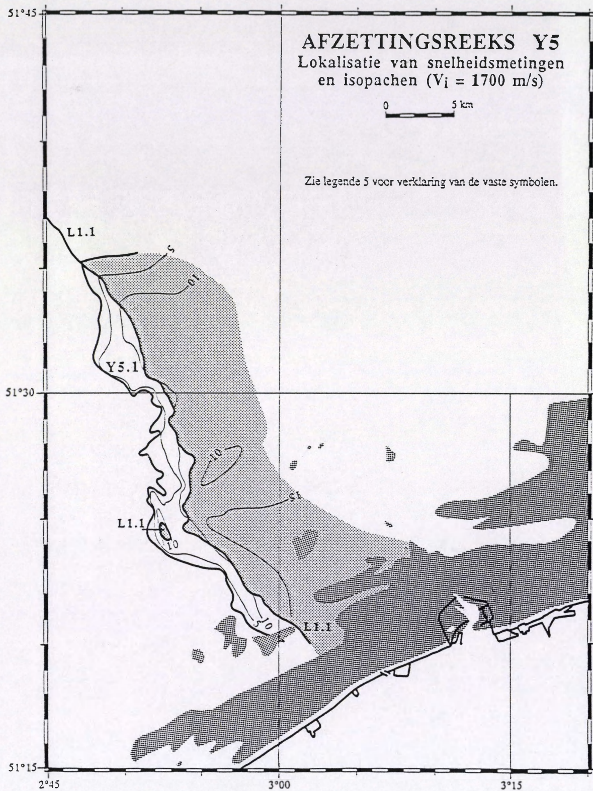
Figuur 62. Seismostratigrafische interpretatiekaart. Afzettingenreeks Y5 : lokalisatie van snelheidsmetingen en diktekaart (zie ook Legende 5). Diktes werden berekend met een seismische intervalsnelheid van 1700 m/s. Mercatorprojectie op 51°20'.
