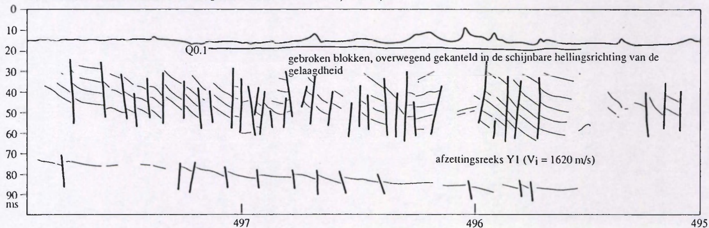
Figuur 112. Seismisch profiel in het centrale deel van het studiegebied, dat gebroken en preferentieel in de hellingsrichting gekantelde blokken in het bovenste interval van de Y1-afzettingenreeks weergeeft.
