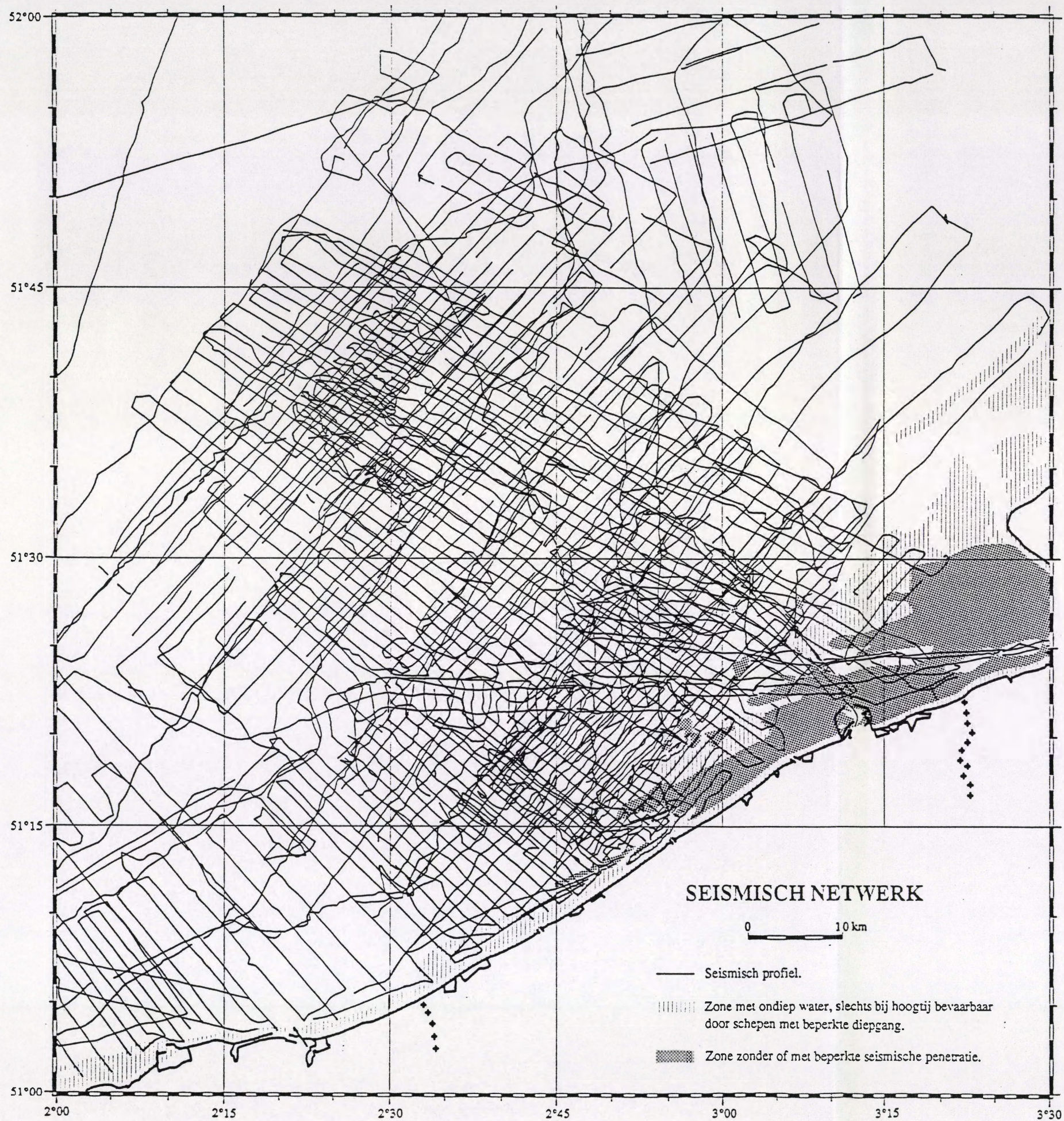
Figuur 16. Seismisch netwerk, gebruikt voor de stratigrafische en structurele interpretatie. Mercatorprojectie op 51°20'.
