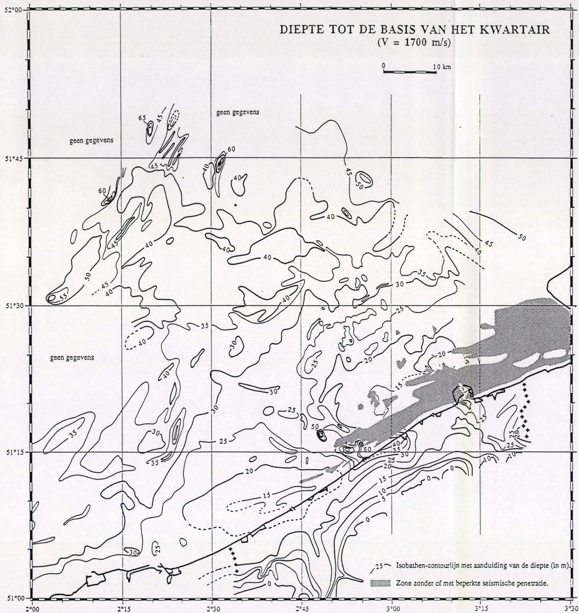
Figuur 20. Dieptekaart tot de basis van de Kwartaire afzettingen. Mercatorprojectie op 51° 20'. Referentieniveau : MLLWS. Diepten werden berekend aan de hand van een gemiddelde seismische snelheid van 1700 m/s. Landgedeelte gekompileerd naar : BAETEMAN (1981), DE BREUCK & DE MOOR (1974), DEPRET (1983), DEVOS (1984), MOSTAERT (1985) en SOMME (1979).
