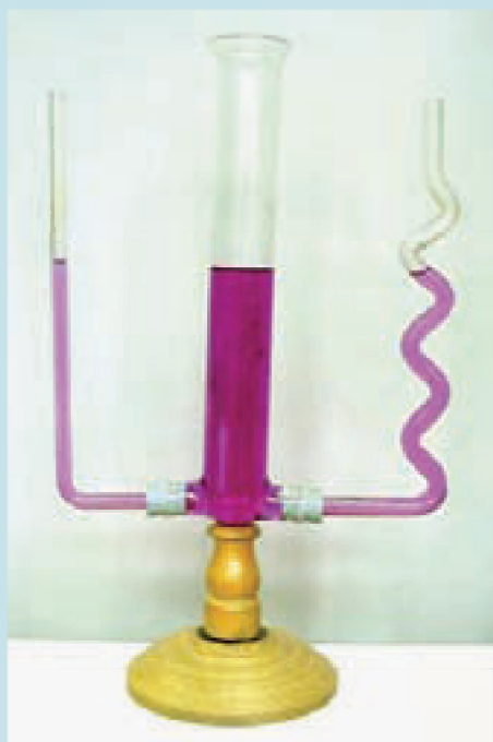
■ Wet van de communicerende vaten: om het even welke vorm het 'vat' heeft, het water stijgt altijd tot eenzelfde hoogte wanneer deze vaten met elkaar in verbinding staan ( http://fys.kuleuven.be/pradem/images-print/comvaten.jpg )
