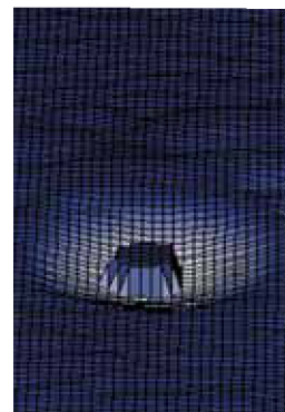
⚡ Erosieput rond een paalfundering, veroorzaakt door een combinatie van golven en stroming (getijdewerking). Links de foto van een labotest, rechts het overeenstemmende resultaat, bekomen door een 3 dimensionale opmeting van het terrein rond de paal.
