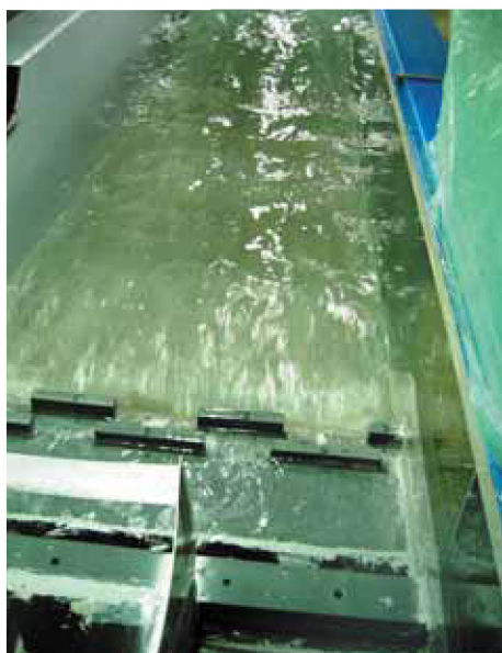
⚡ Schaalmodel in de golfkooi van het Stilling Wave Basin. De aankomende golven stoten op een geschrante dubbel muurtje, waardoor ze omhoogspatten en hun energie verliezen.
