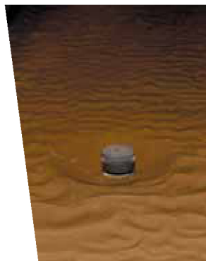
⚡ Erosieput rond een paalfundering, veroorzaakt door een combinatie van golven en stroming (getijdewerking). Links de foto van een labotest, rechts het overeenstemmende resultaat, bekomen door een 3 dimensionale opmeting van het terrein rond de paal.
