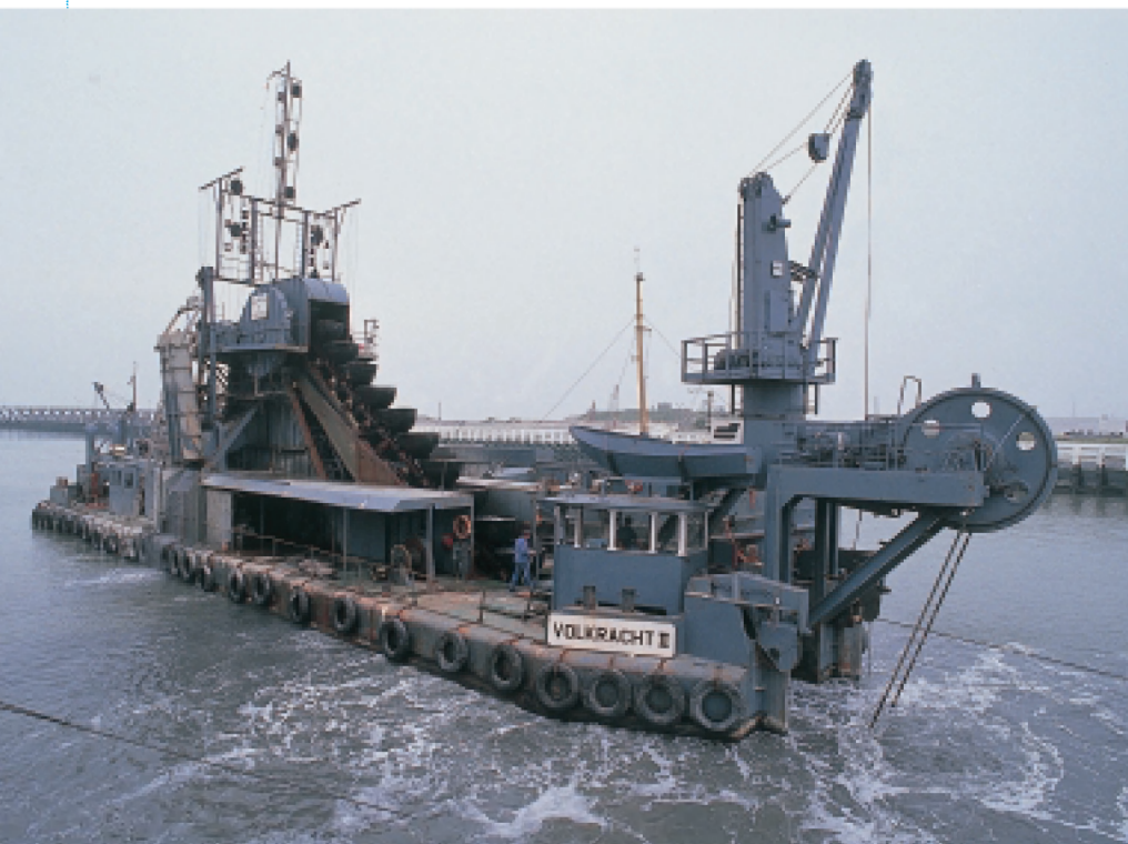
De emmerbaggermolen is het oudste baggerwerktuig nog actief aan onze kust. Hier de 'Volkrecht II' in volle actie in de haven van Oostende (MD)
