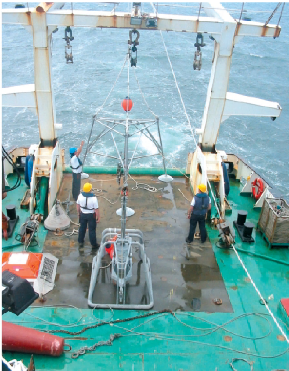
De centrale depressie op de Kwintebank wordt nauwgezet onderzocht binnen het MAREBASSE project. Hier een beeld genomen tijdens een bemonsteringscampagne aan boord van het onderzoeksschip 'Belgica', waarbij zowel bodemkarakteristieken worden bemonsterd als metingen verricht van de hydrodynamiek (RCMG)
