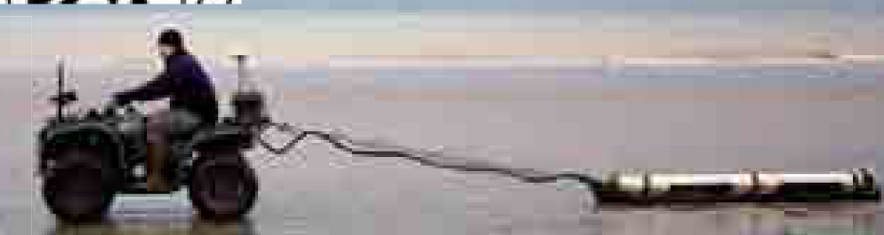
Mesures d'inductions électromagnétiques à l'aide d'une sonde Dualem-21S tractée par un véhicule tout-terrain sur la plage (BE). © K. Vandevorst/Onroerend Erfgoed/A2S
